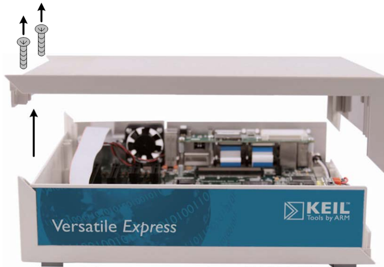
図2. Motherboard ケース取り外し②
