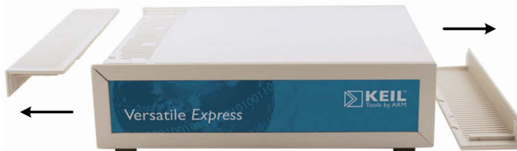
図1. Motherboard ケース取り外し①
